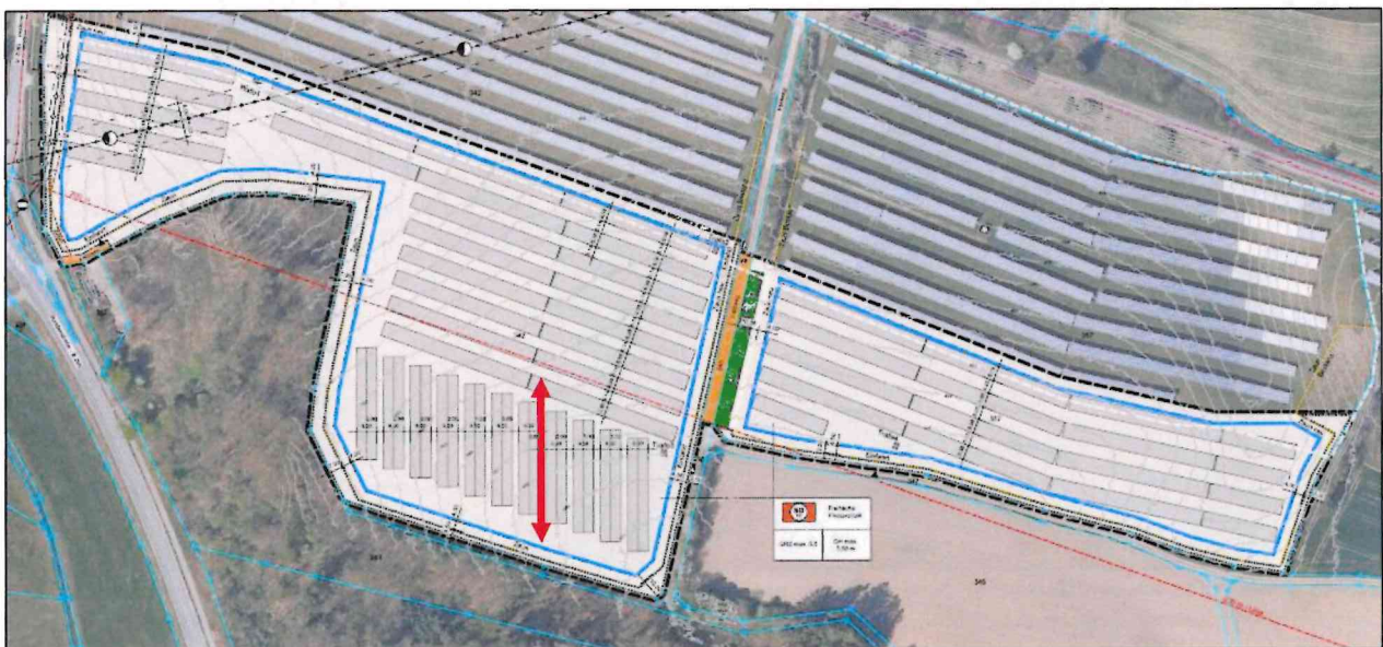
Abb. 14.8.1, vier Trafos, von denen der westliche schlecht anfahrbar ist. Module des südlichen Anlagenteils in Nord-Süd-Ausrichtung
