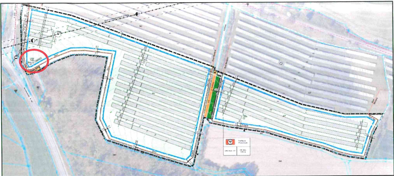
Abb. 14.8.3, zwei Trafos, von der Mittelerschließung anfahrbar sowie eine Übergabestation, ein kombinierter Trafo mit Übergabestation und ein Speicher am südwestlichen Gebietsrand, Optimierung der Modulabstände, Modultische in NW-SO-Ausrichtung geländeangepasst angeordnet.
